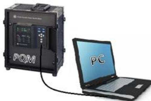
Fig. 2.4: PQM portátil usada en el monitoreo
