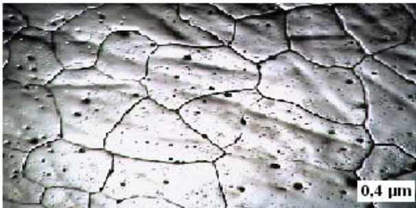
Figura 2.3. Estructura metalográfica del material de la válvula. (40X)
