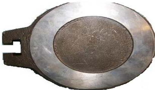
Figura 2.2. Cuña de la válvula en estado fundida.
