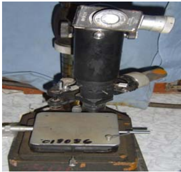
Figura.2.4. Microscopio utilizado para el ensayo de microdureza.
