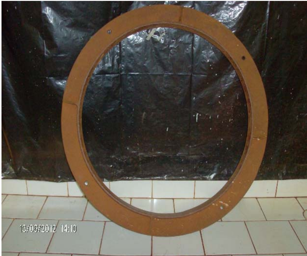
Figura 2. Anillo de acero empleado para determinar la densidad del material.
