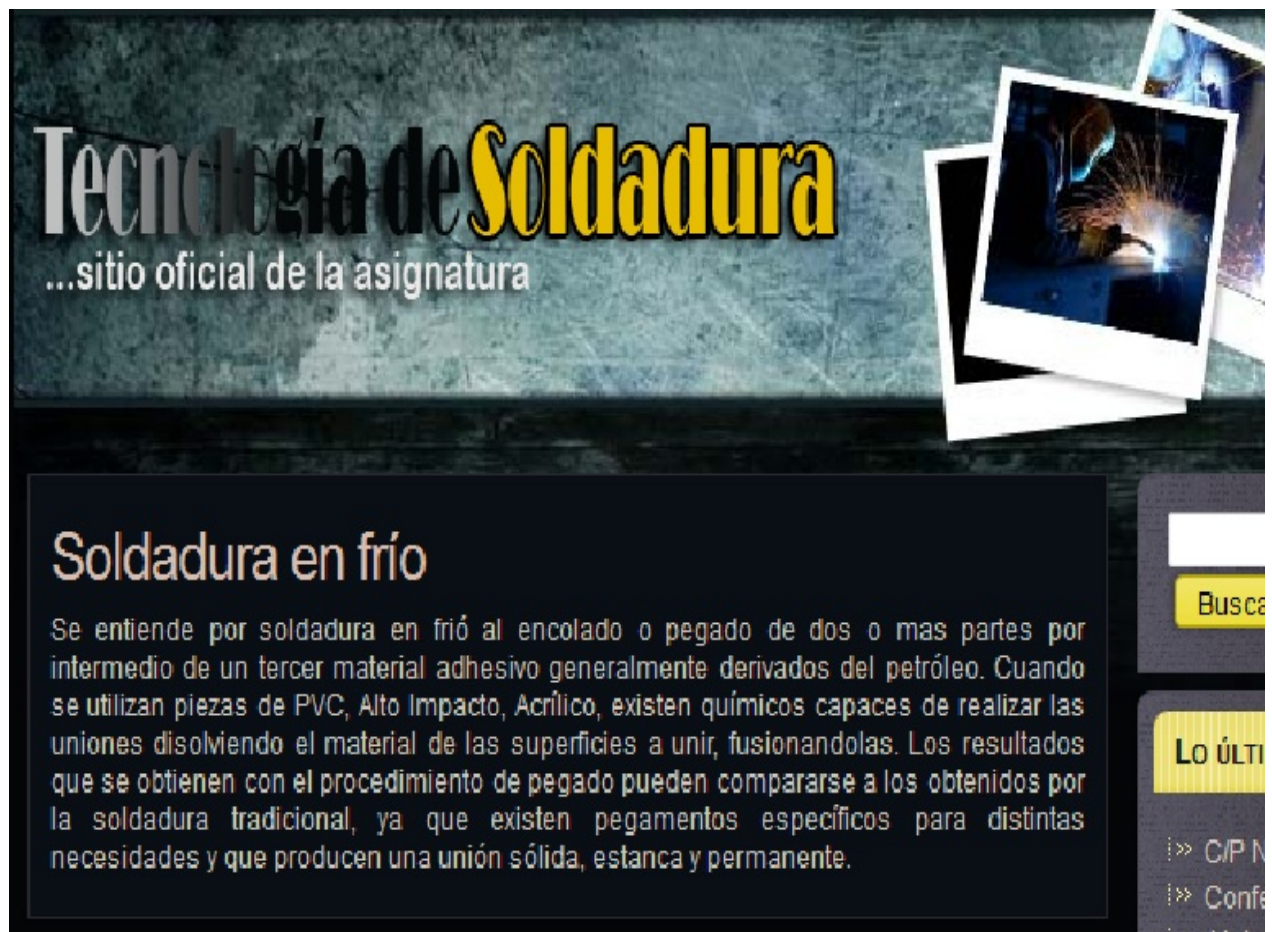
Figura 2.9. Soldadura en frío en el sitio web de la asignatura.
