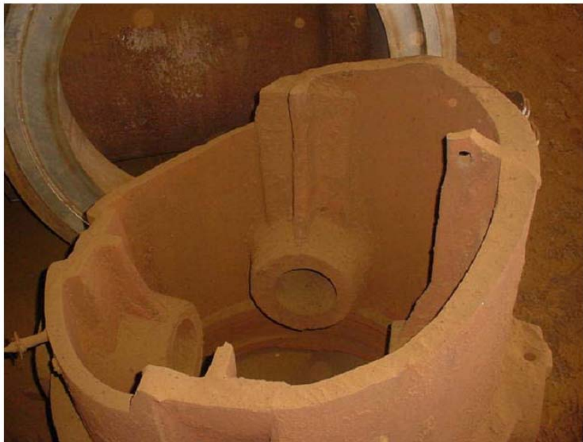
Figura 1.2: Tramo del eje central del horno fracturado por fallo de la estructura cristalográfica del material, pertenece a la zona donde se averió el horno 18.
