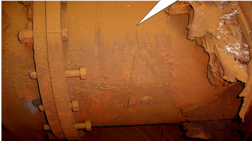
Figura 1.1: Muestra del inicio de una rotura en un tramo de árbol central.
