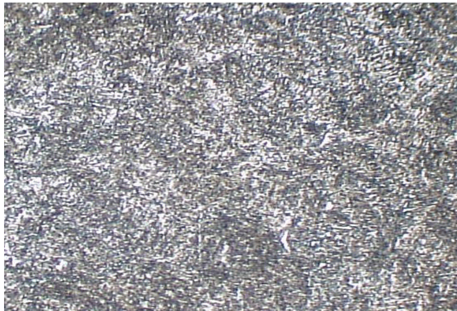
Figura 16. Microestructura del cicüeñal a 200X.
