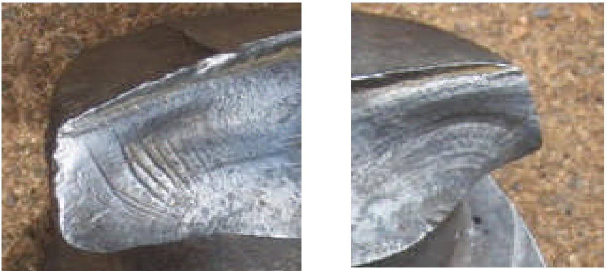
Figura 15. Marcas de playa típicas de la rotura por fatiga
