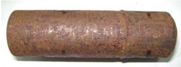
Figura 1. Barra de acero 45 sometida a rodadura.
