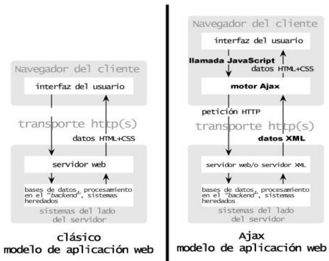
Figura 4 El modelo tradicional para las aplicaciones Web (izq.) comparado con el modelo de AJAX (der.)
