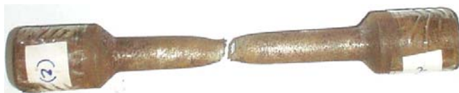
Figura 3.5 Probeta 2 traccionada con fuerza 1 500 N, avance de 0,125 mm/rev y 27 rev/min
