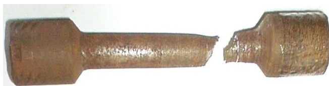
Figura 3.33 Probeta 9 traccionada con fuerza 2 500 N, avance de 0,075 mm/rev y 110 rev/min
