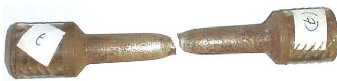
Figura 3.25 Probeta 7 traccionada con fuerza 500 N, avance de 0,075 mm/rev y 54 rev/min Los valores obtenidos para la deformación de la probeta mostrada en la figura 3.25 aparecen en la tabla 3.8.
