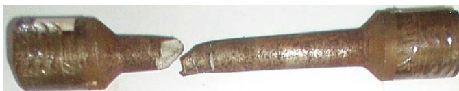
Figura 3.17 Probeta 5 traccionada con fuerza 1 500 N, avance de 0,125 mm/rev y 54 rev/min
