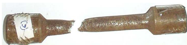
Figura 3.21 Probeta 6 traccionada con fuerza 2 500 N, avance de 0,075 mm/rev y 54 rev/min
