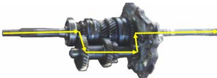
Figura 3.2. Disposición de la primera marcha en la caja de velocidad.
