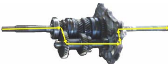
Figura 3.6. Disposición de marcha atrás.
