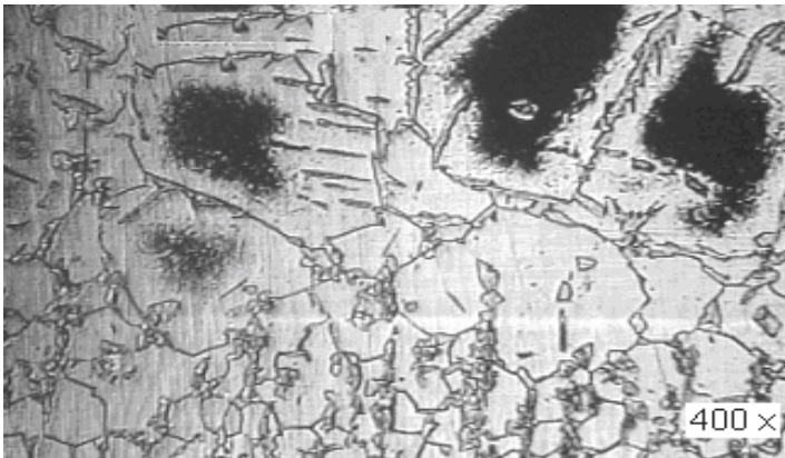
Figura 3.5. Microestructura de la ZAC en el acero AISI 316.
