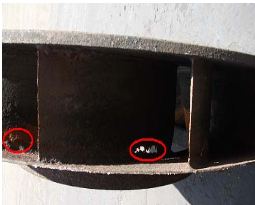
Figura 1. Impelente del ventilador centrífugo del sistema de absorción de amoníaco.
