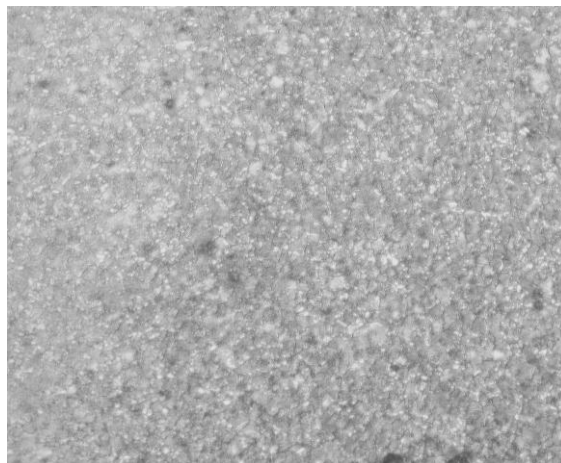
Figura 3.2. Microestructura del asa fabricada en Alemania (100 X).
