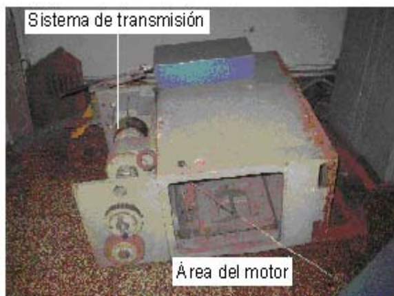
Figura 2.1. Simulador de desgaste CMT 2070 – 1.
