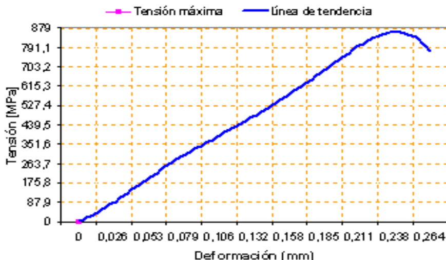
Figura 3.2. Curva \sigma - \epsilon para la 2da probeta.
