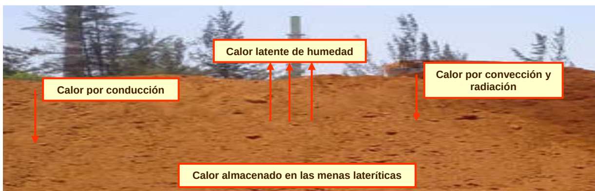
Figura 2.1. Interacción de los calores que intervienen en el secado solar natural de las menas.
