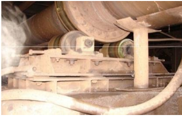
Figura 2.1. Rodillos radiales del transportador Jacobi en explotación junta la llanta.
