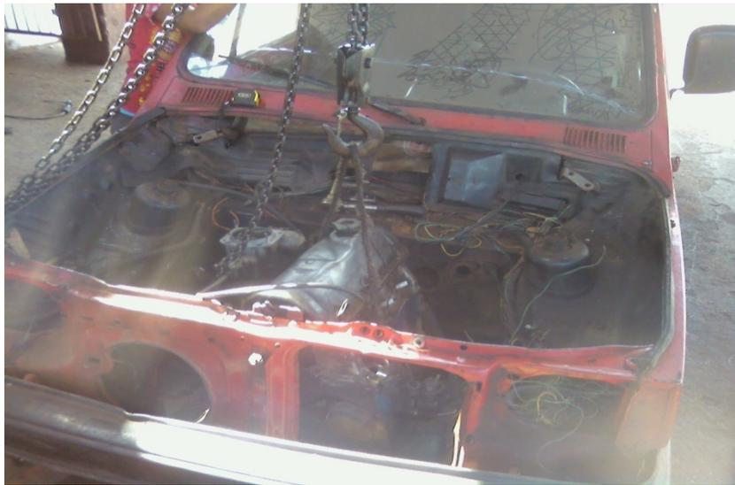
**Figura 3.** Montaje del motor con la grúa.
