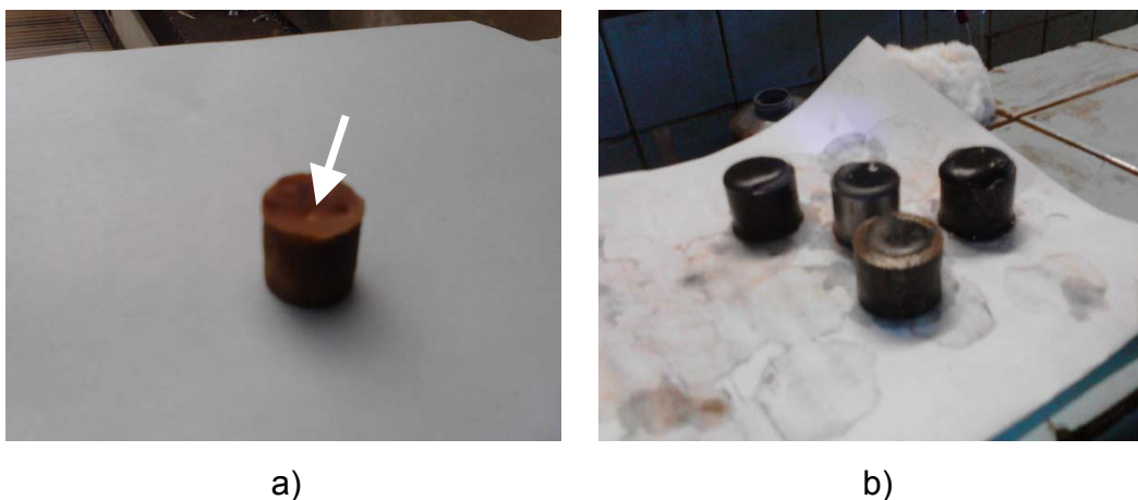
Figura 3.1. Imágenes representativas de las muestras. a) PMMA sin refuerzo después del desmoldeo; b) PMMA reforzado con polvo de grafito durante la gelificación.
