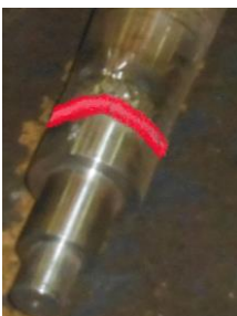
Figura 3.4. Sección de árbol soldado y coloreado
