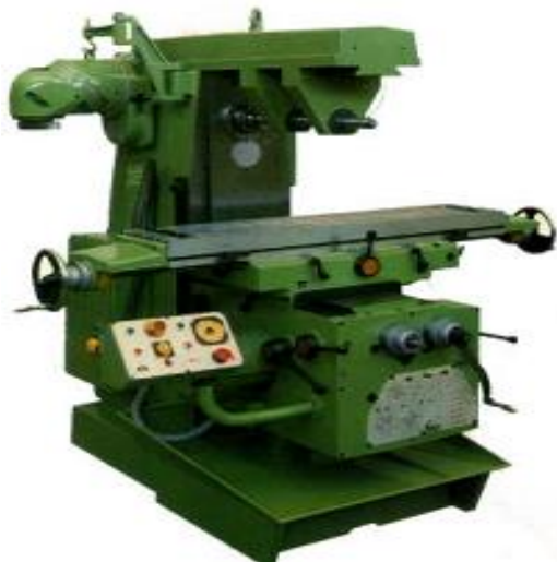
Figura 2.5. Fresadora vertical modelo 6 M 12 L.
