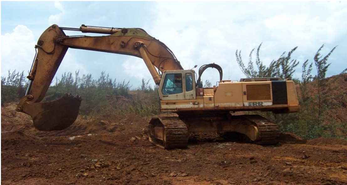
Figura-1. Retroexcavadora LIEBHERR 984, en el destape
