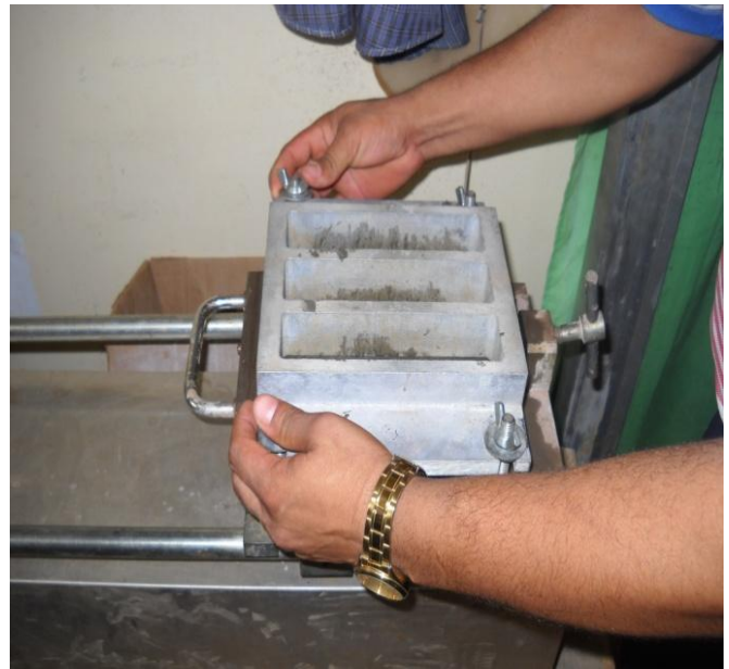
Fotografía # 8. Molde para los morteros.
