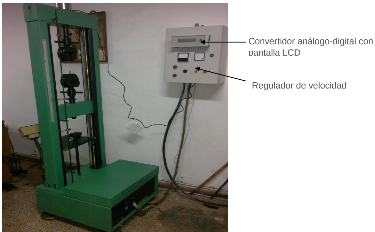
Figura 1. Prensa automatizada con los accesorios contruidos.
