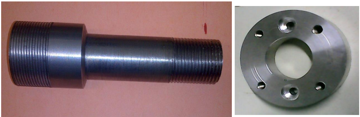
Figura 4. Dispositivo para la unión de la celda de carga a la Prensa.
