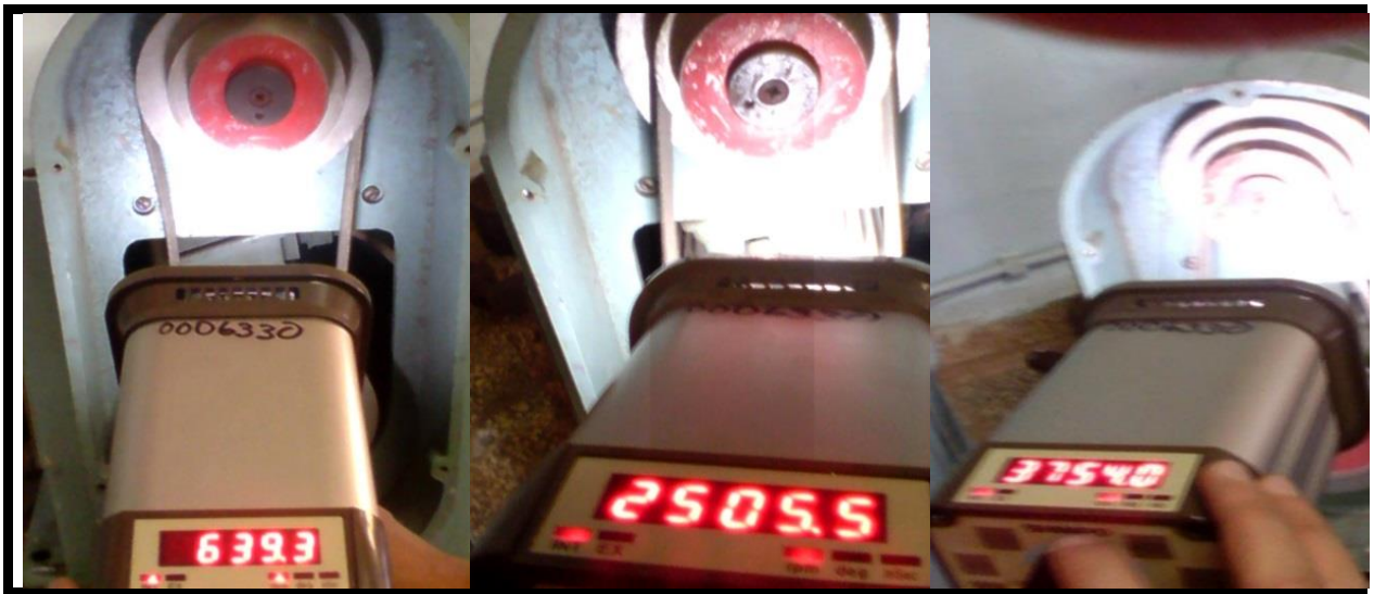
Figura 3.3. Medición de la velocidad de rotación del rodamiento.
