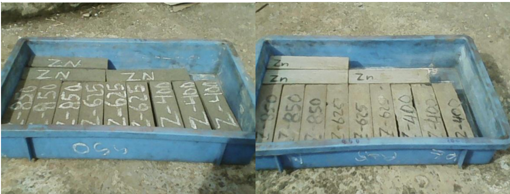
Figura 2.10 Morteros a edades de curado de 7 y 28 días
