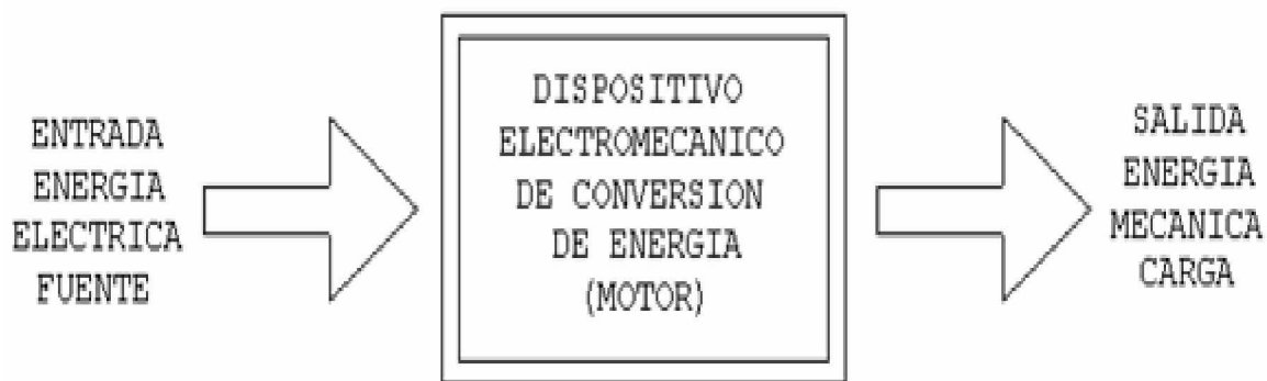
Figura 1.2 Diagrama de bloques de dispositivos electromecánicos de conversión de energía, (motor).
