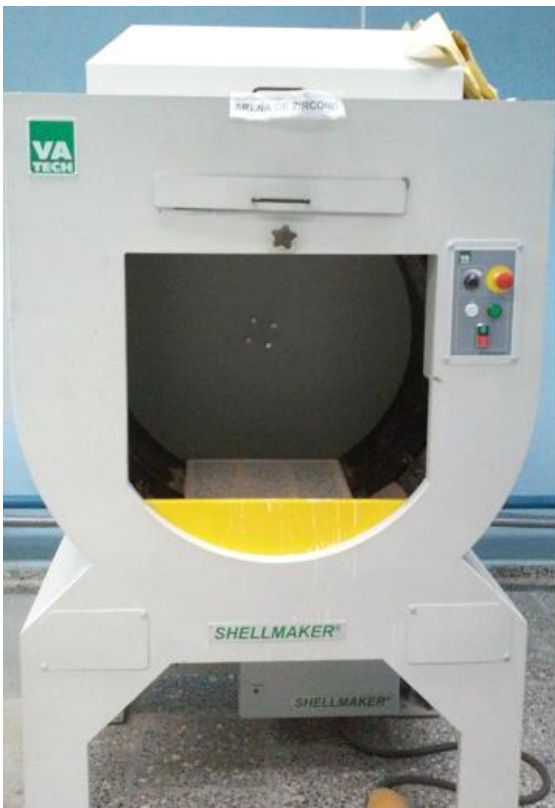
Figura 2.9 Bombo de arena con efecto lluvia para arenas finas.
