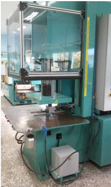
Figura2. 5 Inyectora de cera semiautomática en forma de c.
