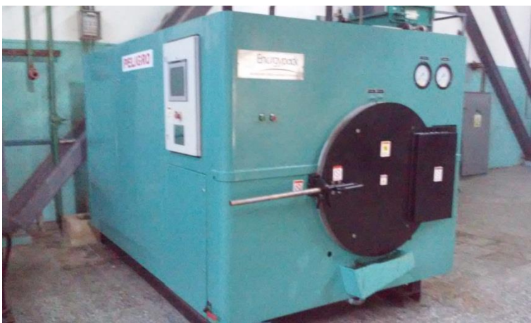
Figura 2.14 Autoclave para descerado.
