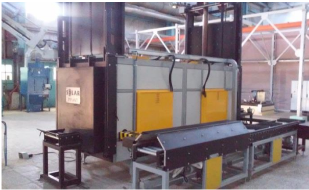
Figura 2.15 Horno de estera para la calcinación de los arbolitos.
