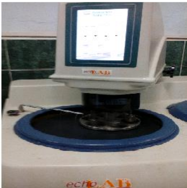
Figura 6. Máquina pulidora metalográfica echoLAB.
