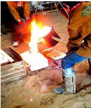
Figura .1 Fundición de metales.
