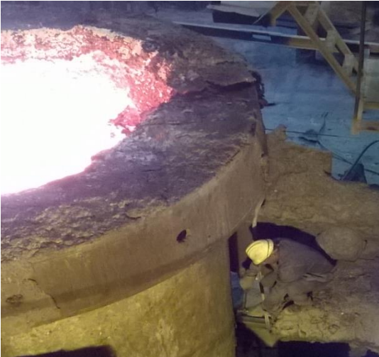
Figura 2.3 Montaje de la manguera de insuflado (Ar o N 2 ) para la agitación en el proceso de HC.
