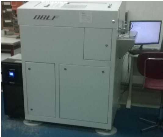
Figura 2.12 Equipo para realizarle al acero la medición de Composición Química OBLF QSG 750-II.
