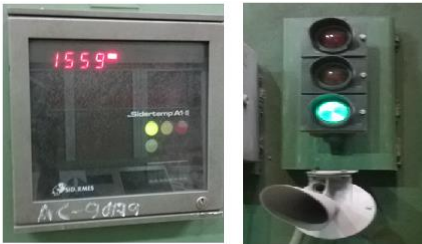
Figura 2.10 Izquierda SIDERMES y derecha semáforo ambos para realizar la toma de temperatura.
