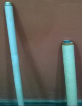
Figura 2.10 Izquierda Termopar y derecha toma muestra, ambos para la realización de la toma de muestra y temperatura.
