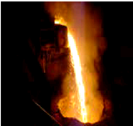
Figura 1.9 Vertido del acero líquido del HAE a la Cazuela. Extraído de V. Morera, 2006.
