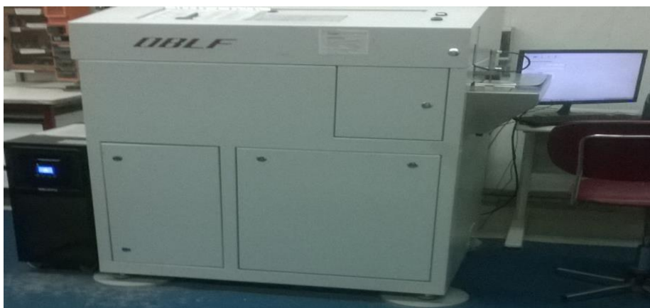
Figura 5. Cuantómetro modelo OBLF QSG 750-II
