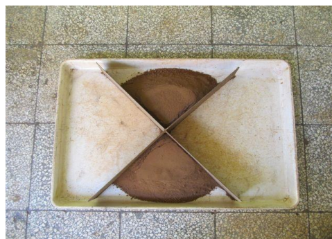
Figura 4. Operación de cuarteo.
