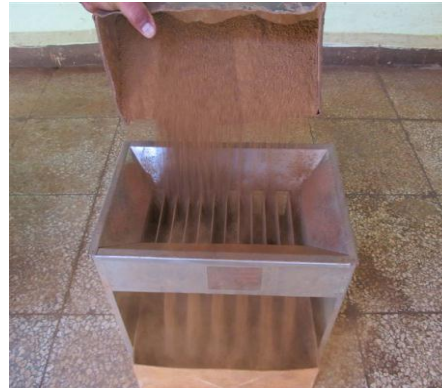
Figura 6. Operación de cuarteo.
