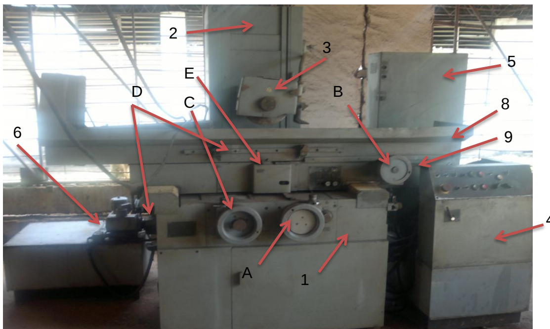
Figura 1.1. Partes principales de la rectificadora plana.
