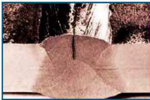
Figura 1.1. Agrietamiento en caliente en un acero inoxidable. Fuente: Muñoz (2009).
