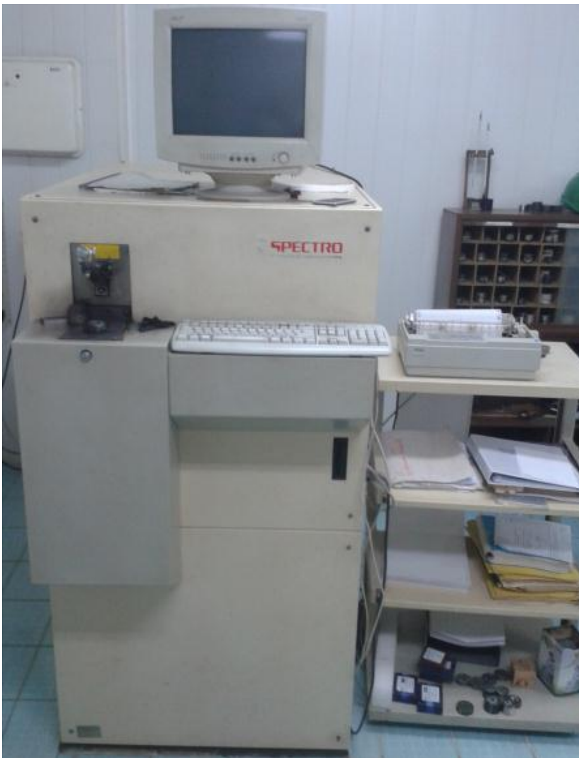
Figura 1. Espectrómetro cuántico de masa Belec Compact Port (Mobile Spectrometer for Metal Analysis) para base hierro, marca SPECTROLAB 230.
