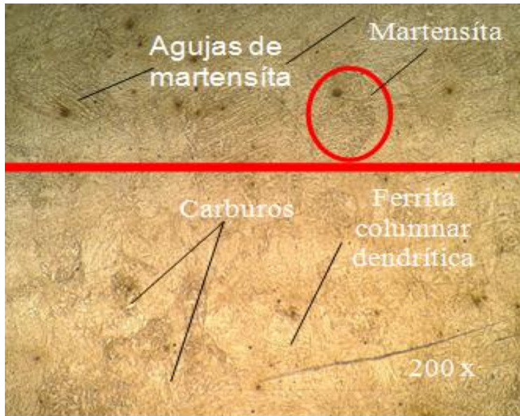
Figura 3.2. Microestructura del acero AISI 4140.
