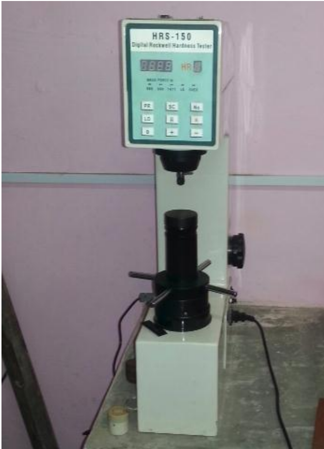
Figura 1. Durómetro digital modelo HRS-ISO.
