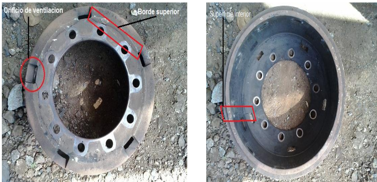
Figura 3.2. Zonas colapsadas de las tambores de freno
