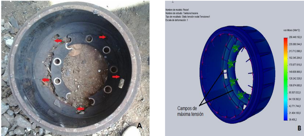
Figura 3.14. Analogías en las probetas (a - probeta física, b - modelo FEM).
