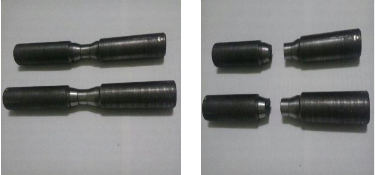
Figura 3.8. Probetas de Fe 21 Ni y Fe 24 antes y después del ensayo.
