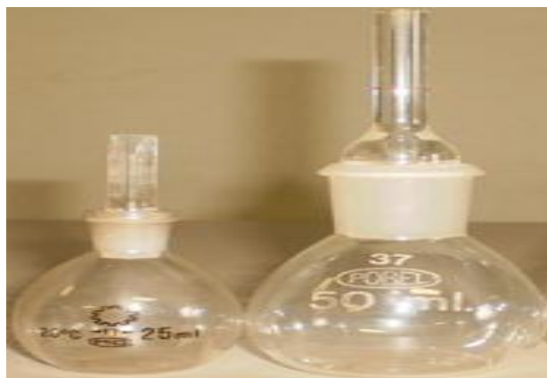
Figura 2.8. Picnómetros que se utilizan para determinar la densidad.
