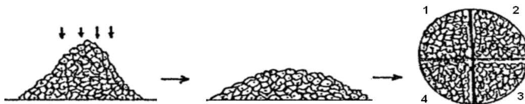
Figura 2.3. Método de cuarteo para la preparación de la muestra.
