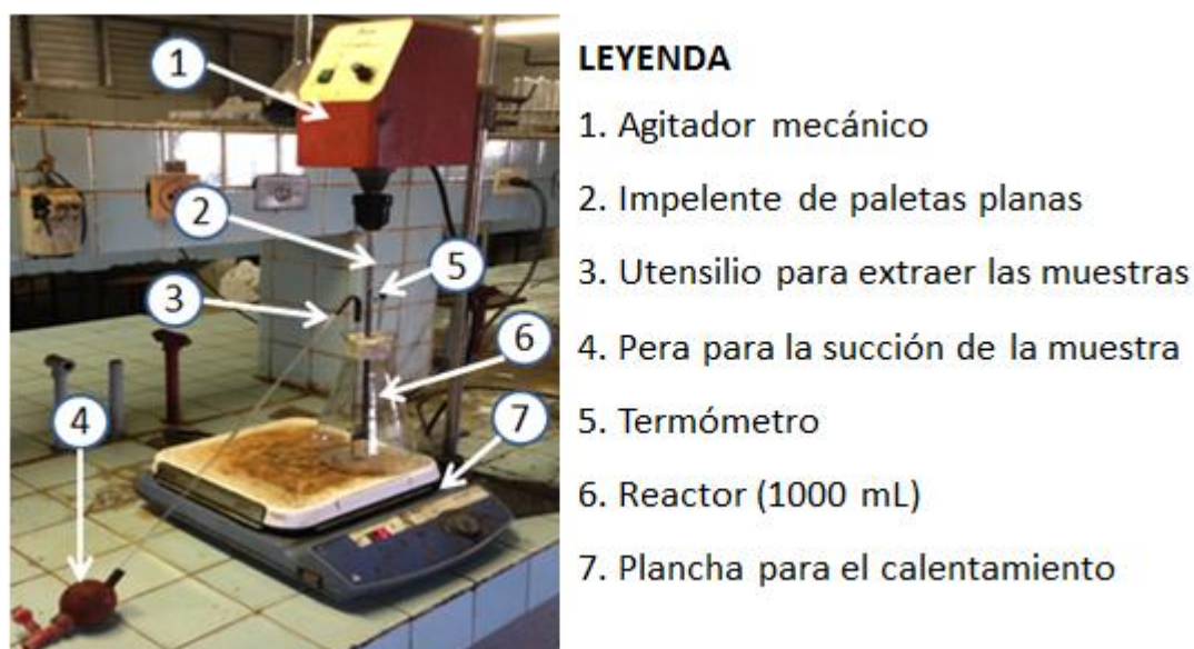
Figura 2.6. Instalación experimental empleada en la lixiviación.
