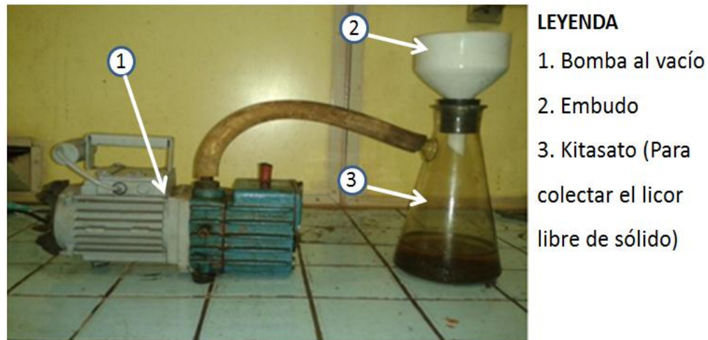
Figura 2.7. Instalación empleado para la filtración.
