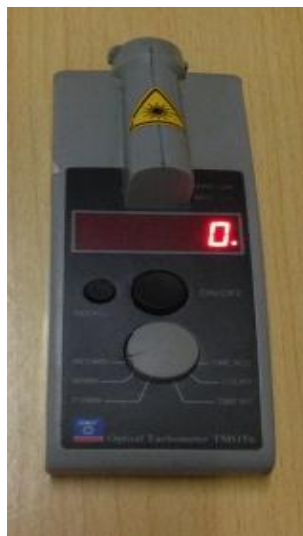
Figura. 2.5: Tipo del tacómetro utilizado.
