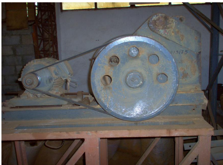
Figura. 2.3: Vista de la trituradora de quijada 320x165 mm.
