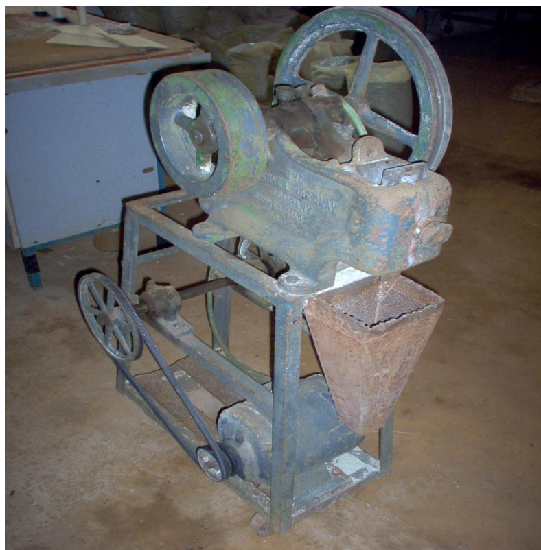
Figura. 2.4: Vista de la trituradora de quijada 150x75 mm.
