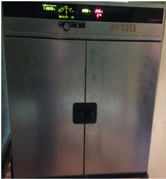
e). Estufa utilizada para secar el material a 120 grado celcius.
