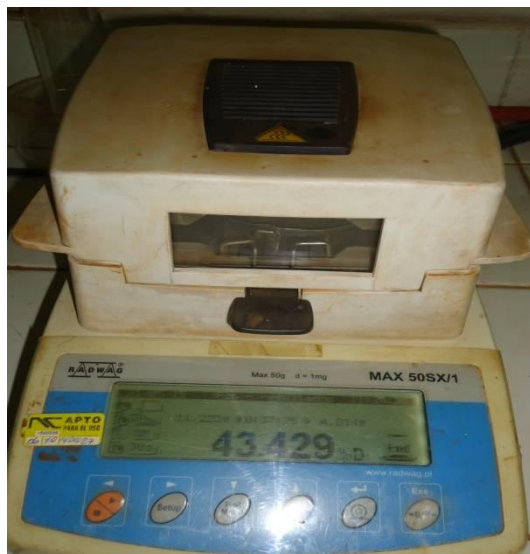
Figura 13.2 Balanza secadora RADWAG, MAX 50 SX/1 para determinar el contenido de sólido.
