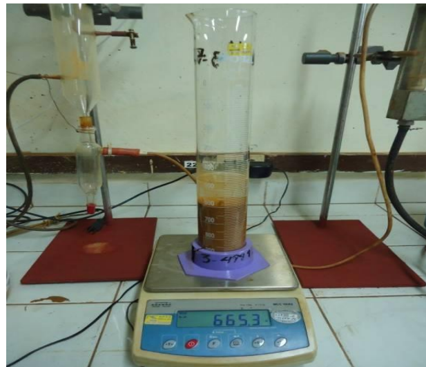
Figura 13.5 Pesa KWEN "FBC", para determinar la densidad.
