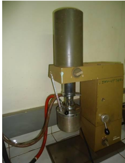
Figura 13.4 Viscosimetro RHEOTEST para las mediciones reologicas.
