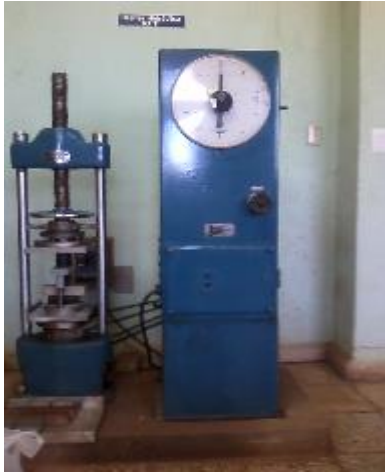
2.13 Prensa hidráulica de 10 t
