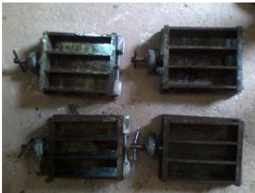
Figura 2.12. Moldes para los morteros
