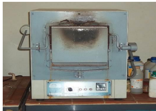
Figura 2.7. Horno eléctrico J P Selecta 2000 367
