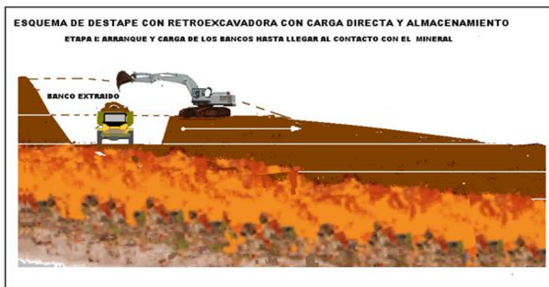
Figura 2.6. Esquema de destape con retroexcavadora con carga directa y almacenamiento (etapa I).
