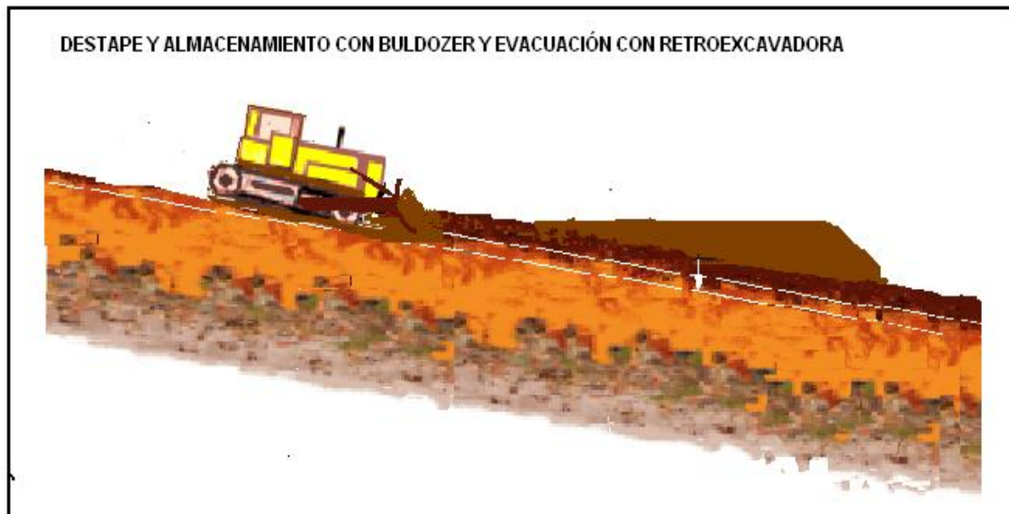
Figura 2.2. Esquema de destape y almacenamiento con buldócer y evacuación con retroexcavadora.
