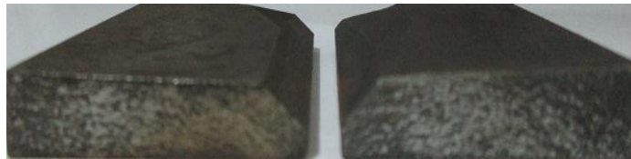
Figura 2.5. Preparación de la junta en las muestras para la soldadura
