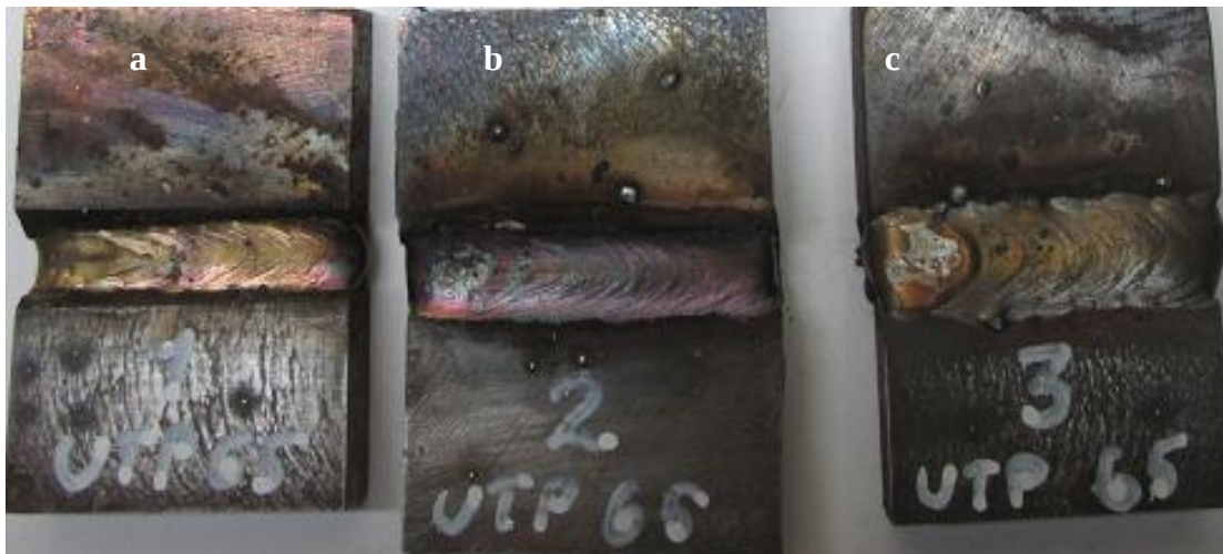
Figura 2.3. Muestras soldadas con electrodos UTP 65.
