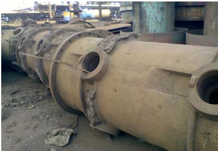
Figura 2.1. Tramos del eje central.
