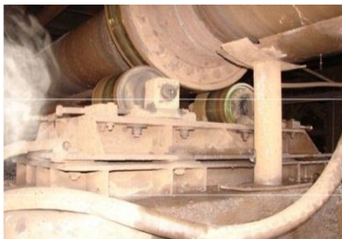
Figura 2.1. Ubicación de los rodillos radiales del transportador sinfín.
