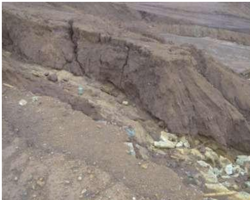
Foto 1.1 Acción de los agentes de intemperismo de la escombrera Q-58 ubicada en el Yacimiento Yagrumaje Norte
