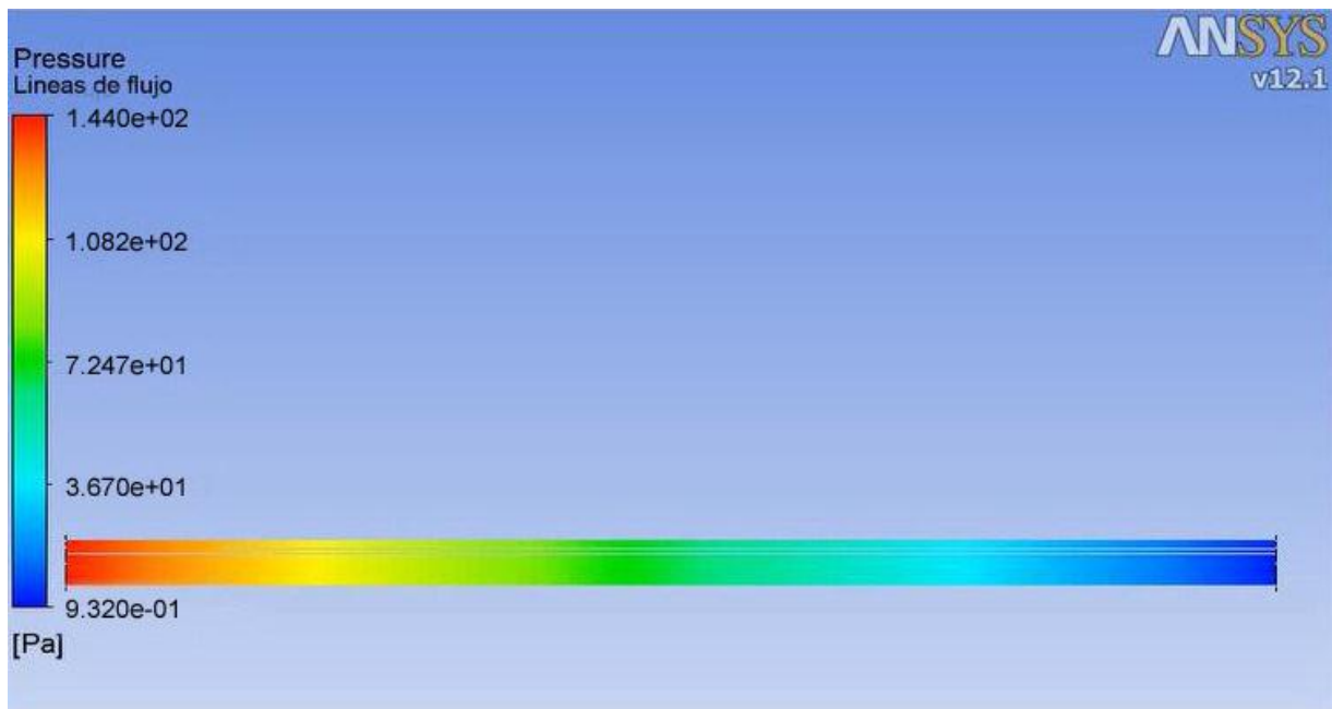
Figura 3.4. Comportamiento de la presión en el interior de la tubería.
