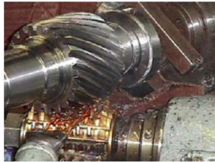
Tallado de un piñón por generación con fresa madre.
