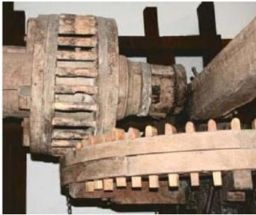
Figura. 1.5. Transmisión de ejes concurrentes con empleo de un engranaje de linterna.
