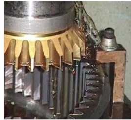
Tallado de una corona de dentado interior con un piñón mortajador.
