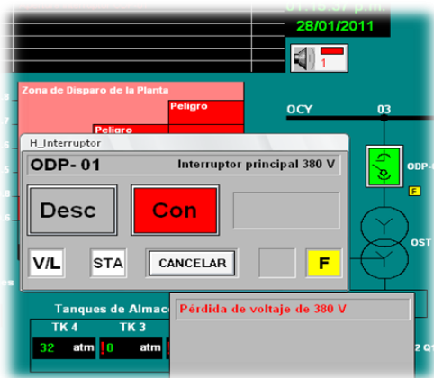
Fig.1.26 Información del interruptor en falla
