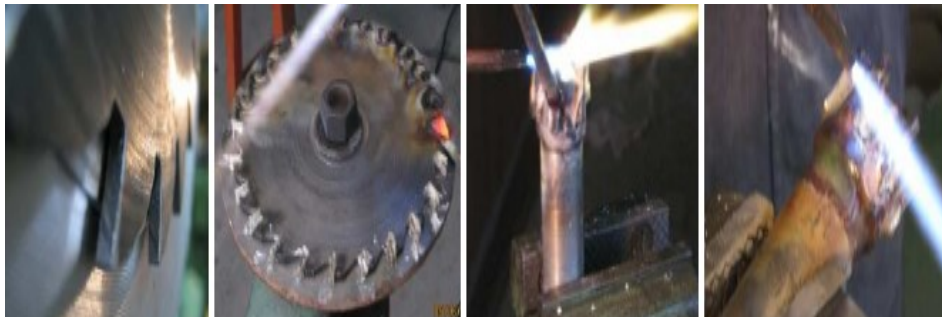
Figura 1.4. Soldadura de inserto con llama oxiacetilénica.
