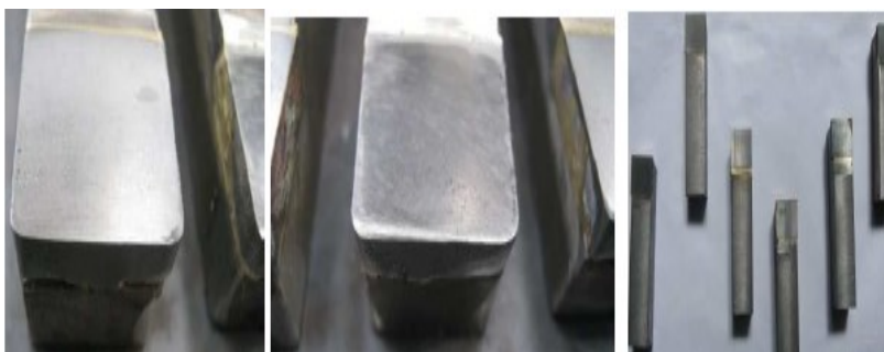
Figura 1.5. Preparación del material para la soldadura del inserto.
