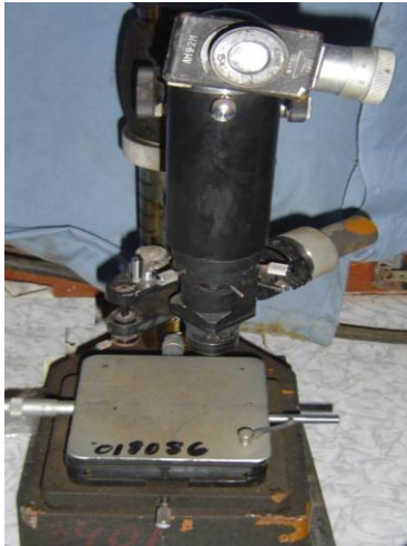
Figura 2.9. Microscopio metalográfico para medición de microdureza.
