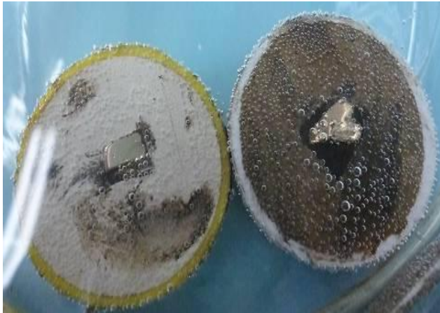
Figura 2.7. Ataque químico de las muestras
