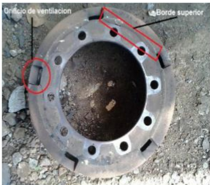
Figura 3.1. Zonas averiadas de las tambores de freno.
