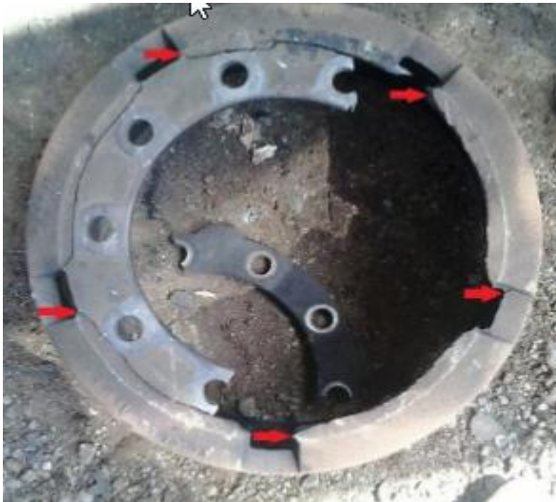
Figura 3.2. Concentraciones de tensión en las tambores de freno.
