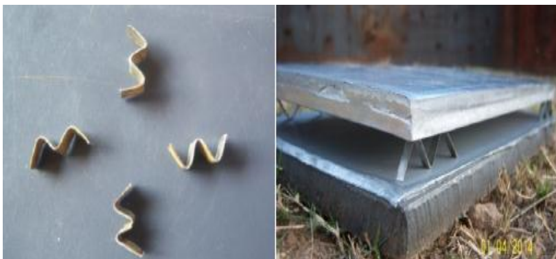
Figura 1.6. Espaciadores empleados en la soldadura. Fuente: Raghu et al. (2004).
