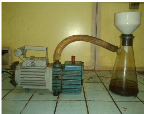
Figura 2.4 Instalación de filtración
