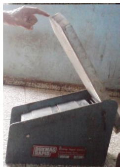
Figura 10: Canaleta magnética F. A. Magnachute para la corrida de experimentos.
