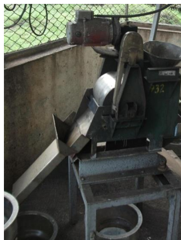
Figura 8: Separador magnético de tambor húmedo WD-WADR 190x150.
