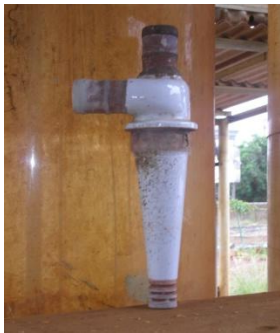
Figura 9: Hidrociclón de laboratorio para la corrida.
