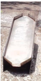
Figura 10: Canaleta magnética F. A. Magnachute para la corrida de experimentos.
