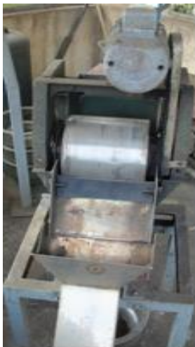
Figura 8: Separador magnético de tambor húmedo WD-WADR 190x150.
