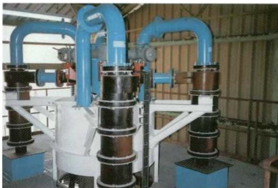
Figura 5: Hidrociclón cilíndrico AKW (Ø200 mm).
