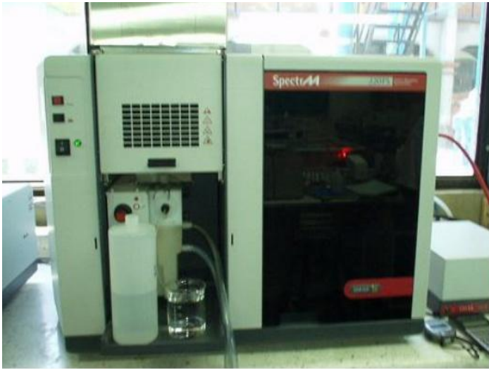
Figura 13: Espectrofotómetro de absorción atómica (modelo Spectra 220FS).
