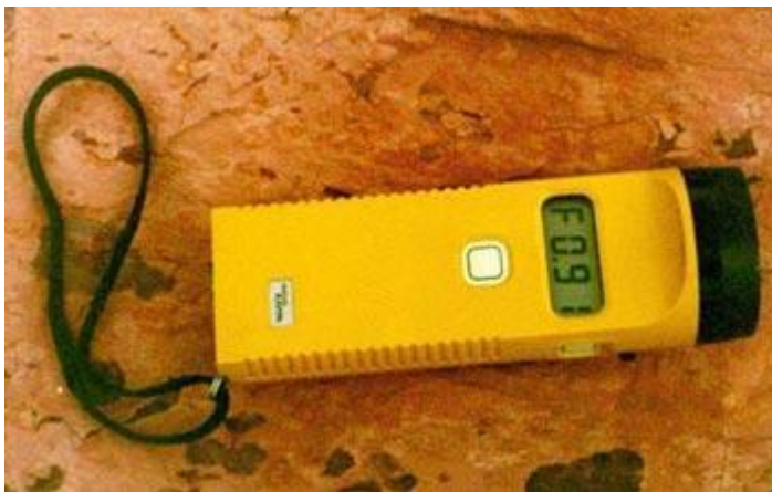
Figura 14: Equipo de análisis de susceptibilidad magnética.
